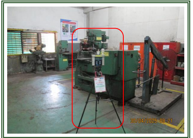
รูปที่ 4.2-42 แสดงจุดตรวจวัดระดับความร้อนในการทำงาน บริเวณ Guide Shop ตรวจวัดในวันที่ 30 เมษายน 2568
