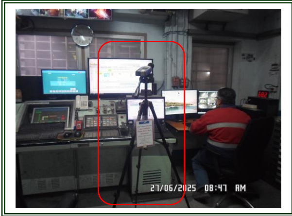
รูปที่ 4.2-45 แสดงจุดตรวจวัดระดับเสียงในพื้นที่ทำงาน บริเวณห้อง Control LF ตรวจวัดในวันที่ 27 มิถุนายน 2568
