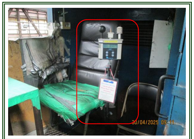
รูปที่ 4.2-44 แสดงจุดตรวจวัดระดับความร้อนในการทำงาน บริเวณควบคุม Turn Foaming Head ตรวจวัดในวันที่ 30 เมษายน 2568
