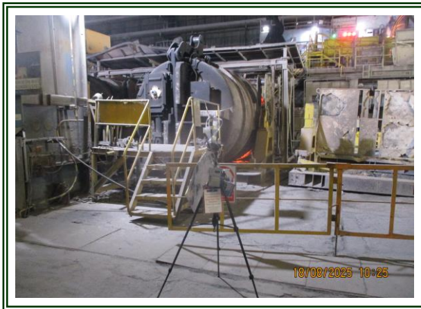
รูปที่ 4.2-36 แสดงจุดตรวจวัดคุณภาพอากาศในพื้นที่ทำงาน บริเวณห่างจากเตาหลอมด้านหน้าเหล็กประมาณ 10 เมตร ตรวจวัดในวันที่ 18 สิงหาคม และ 2 พฤศจิกายน 2568
